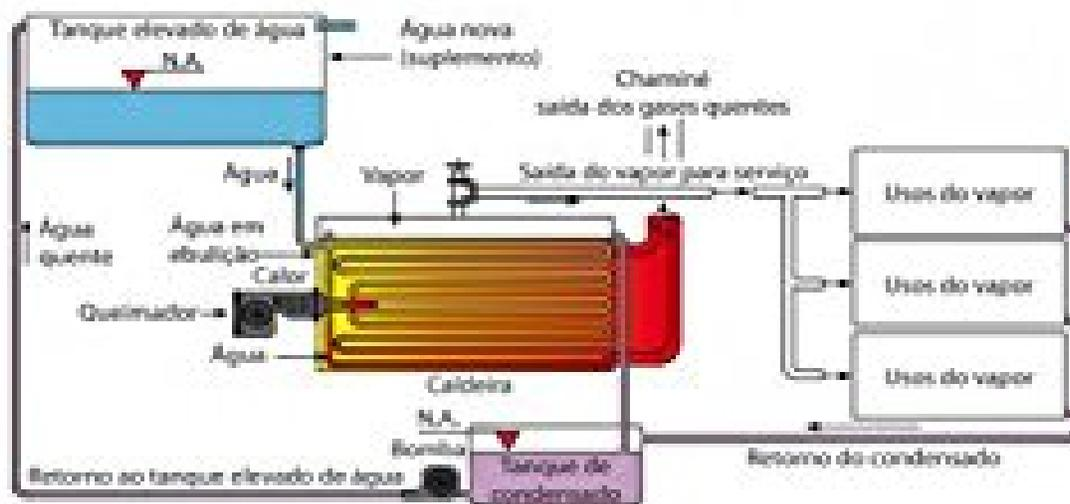
Esquema básico de uma instalação a vapor
